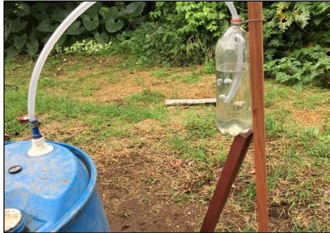
**Fotografía 2-3.** Sistema de evacuación de gases del biodigestor.
