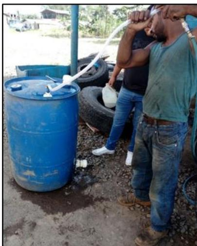
**Fotografía 4-3.** Prueba de hermeticidad ejecutada a los biodigestores.
