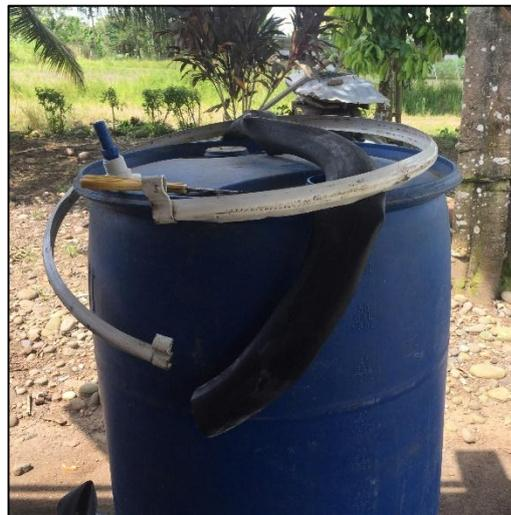
**Fotografía 3-3.** Abrazadera metálica y empaque de caucho utilizados para el cierre hermético del tanque
