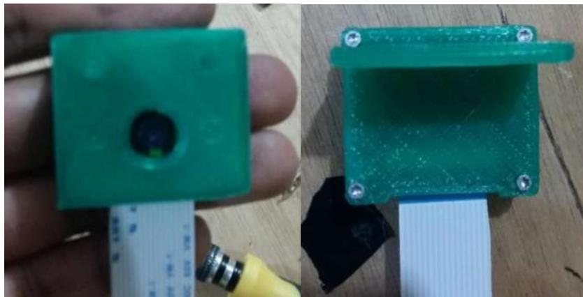
**Figura 33-3:** Parte frontal y trasera de la Pi camera con su carcasa.
