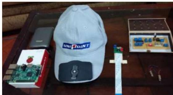
**Figura 42-3:** Dispositivos a colocar en la gorra.
