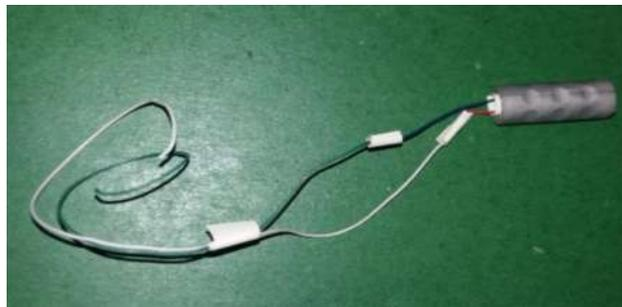
**Figura 41-3:** Micro-motor en cápsula para vibración.
