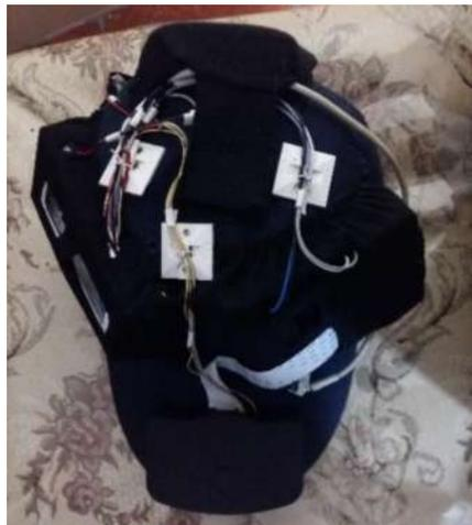
**Figura 51-3:** Conexiones distribuidas a través de bridas.
