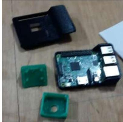
**Figura 32-3:** Carcasa de Raspberry Pi 3 y cámara Pi.
