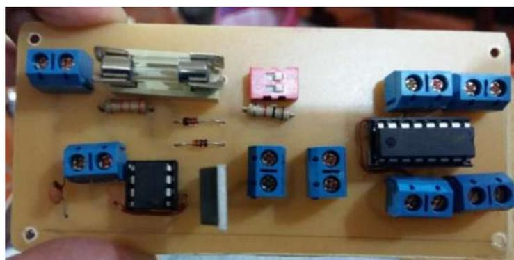
**Figura 23-3:** Placa final utilizada en el prototipo electrónico.
