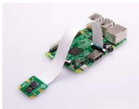
**Figura 7-2:** Cámara Raspberry Pi.
