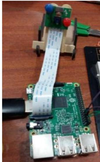
**Figura 18-3:** Conexión de la cámara Pi a la Raspberry.
