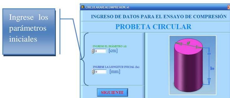
**Figura 5.29:** Representación gráfica de la ventana de ingreso de datos de la probeta circular del ensayo de compresión
