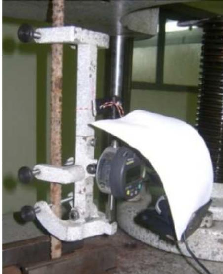
**Figura 4.14:** Representación gráfica del montaje de la probeta en la Máquina Universal para el ensayo de tracción
