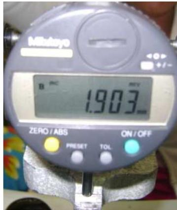
**Figura 4.7:** Representación gráfica del valor de la deformación de 1.903mm en el display del deformímetro.
