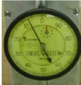
**Figura 4.11:** Representación gráfica del valor del desplazamiento de 7 que corresponde a 0,35 mm en el del deformímetro de palanca.
