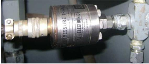
**Figura 2.1:** Representación gráfica del Transductor de presión instalado en la Máquina Universal
