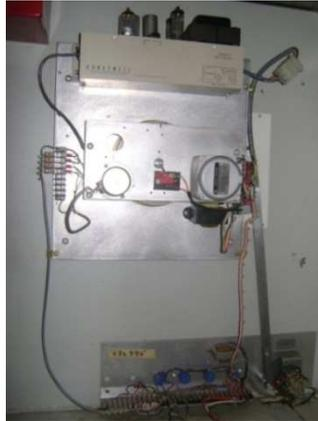
**Figura 2.4:** Representación gráfica del circuito electrónico analógico instalado en la Máquina Universal
