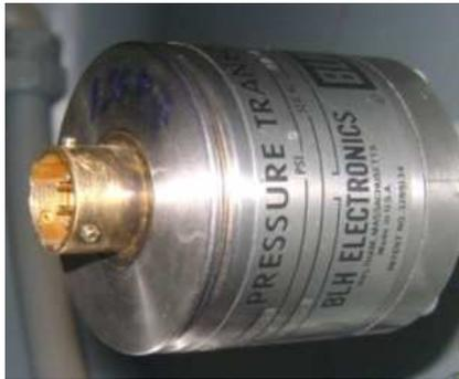
**Figura 3.1:** Representación grafica del transductor de presión PRESSURE TRANSDUCER BHL ELECTRONICS N° serie 48783
