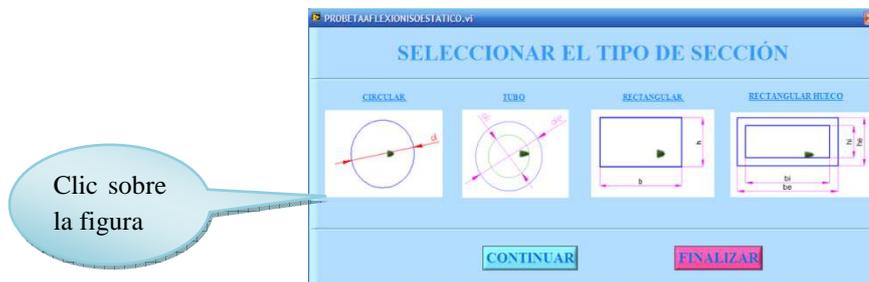
**Figura 5.34:** Representación gráfica de la ventana de selección del tipo de sección de probetas del ensayo de flexión isoestático
