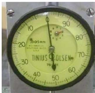
**Figura 4.9:** Representación gráfica del enceramiento del valor de desplazamiento encerado en el deformímetro de palanca
