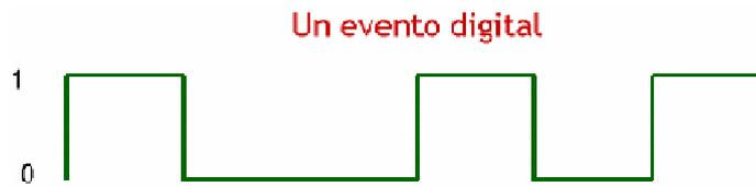
**Figura 2.23:** Representación gráfica de una señal digital integrada por valores discretos de ceros y unos
