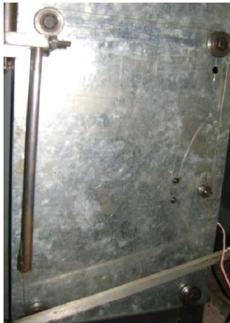
**Figura 3.15:** Representación gráfica del mecanismo de poleas (del encoder)
