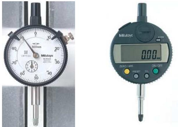
**Figura 2.7:** Representación gráfica del deformímetro analógico y del reloj comparador
