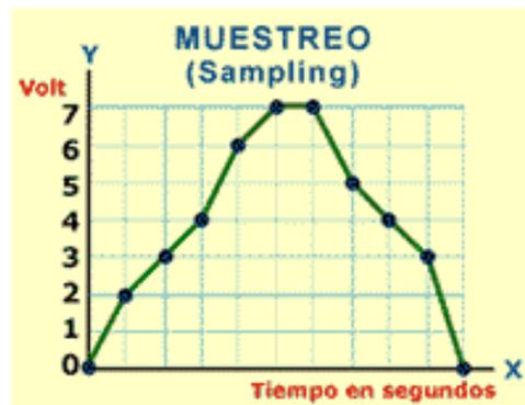
**Figura 2.29:** Representación gráfica del muestreo de una señal analógica (Sampling)
