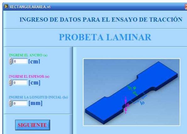
**Figura 5.25:** Representación gráfica de la ventana de ingreso de datos de la probeta laminar del ensayo de tracción
