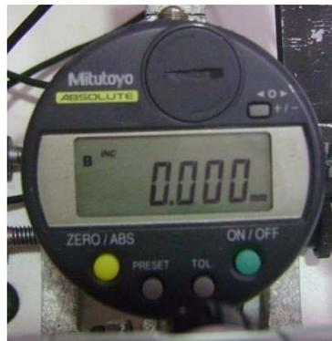
**Figura 4.5:** Representación gráfica del enceramiento del valor de la deformación encerado en el display del deformímetro.
