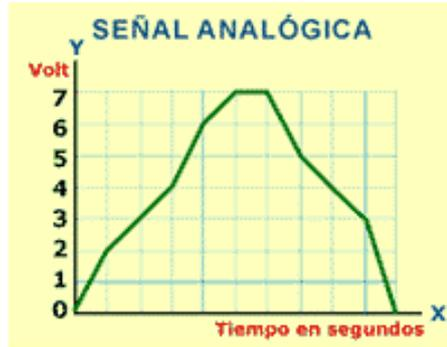
**Figura 2.28:** Representación gráfica de la señal analógica de medio ciclo positivo
