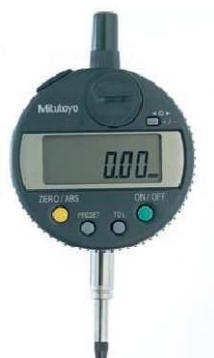
**Figura 2.16:** Representación gráfica del reloj comparador digital
