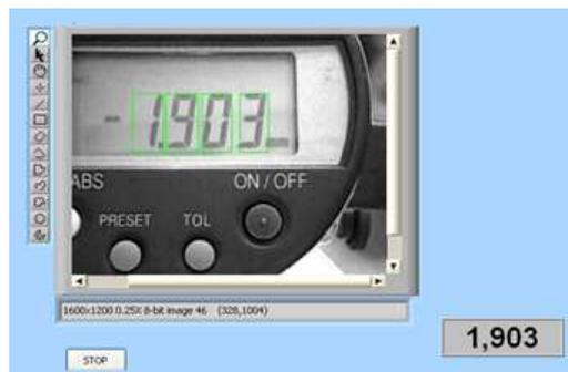
**Figura 4.8:** Representación gráfica del valor de la deformación de 1.903mm en el programa.
