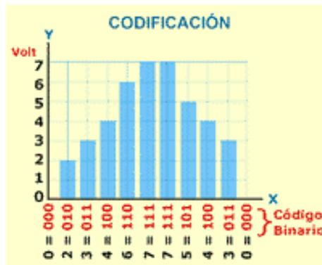
**Figura 2.32:** Representación gráfica de la codificación de la señal digital en código numérico binario
