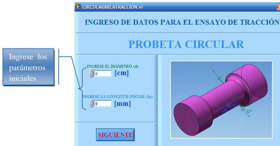
**Figura 5.6:** Representación gráfica de la ventana de ingreso de datos de la probeta circular del ensayo de tracción
