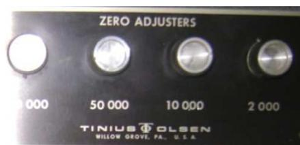
**Figura 2.6:** Representación gráfica ajustadores de cero para encerrar la Máquina Universal.
