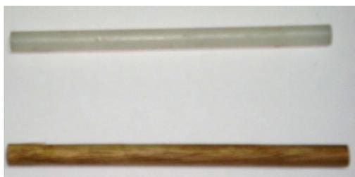
**Figura 1.10:** Representación gráfica de los tipos de probetas para el ensayo de corte.
