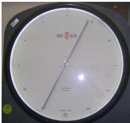
**Figura 4.1:** Representación gráfica del enceramiento del valor de la fuerza encerado en el dial de la Máquina Universal
