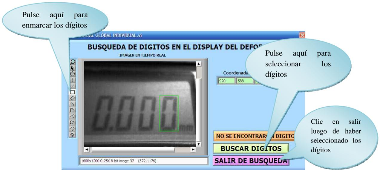
**Figura 5.12:** Representación gráfica de la ventana de búsqueda de dígitos del display del deformímetro
