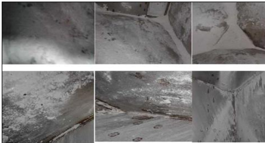
Figura 4-1. Pérdidas de material en las paredes del equipo mezclador Fuente: (SEYQUIIN CÍA. LTDA 2012)
