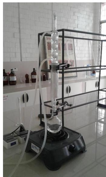
Se efectúa un tratamiento de 3,0 horas, con un equipo de extracción continua de grasas y aceites esenciales (Soxhlet) empleando Hexano como solvente de extracción. Removiendo los aceites esenciales contenidos en la cáscara de naranja.
