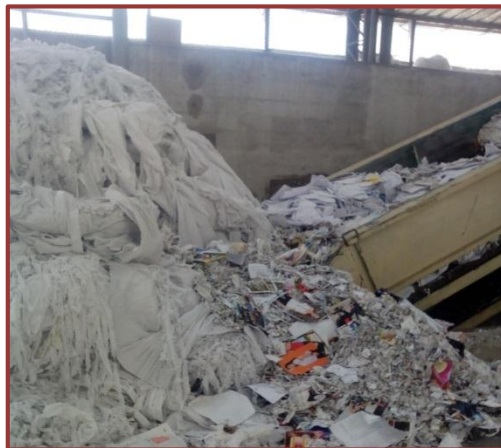
Figura 2-1: Disposición de materia prima en la banda transportadora hacia el Pulper.
