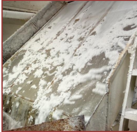
Figura 63-1: Equipo para limpieza y espesado (Columna metálica espesadora).
