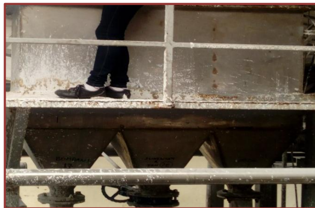
Figura 30-1: Equipo para mantener la consistencia de la pasta estable (Caja de nivel 1).
