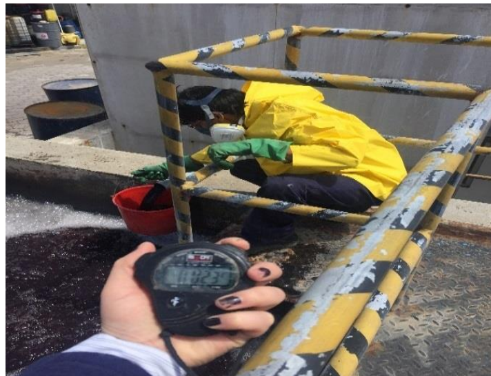
Fotografía 2-3: Medición de caudal.
