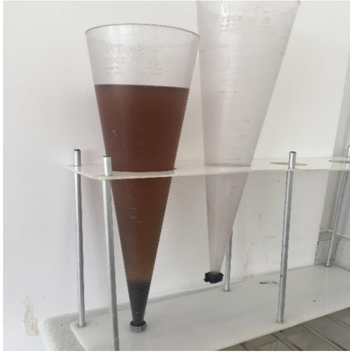
Fotografía 3-3: Sedimentación de lodos en cono Imhoff.
