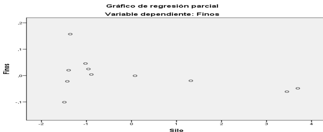
Gráfico 3-57 Regresión parcial de los finos con respecto al número de silo (tabla 3-53), en el método de regresión lineal múltiple para los silos 5, 9 y 4.
