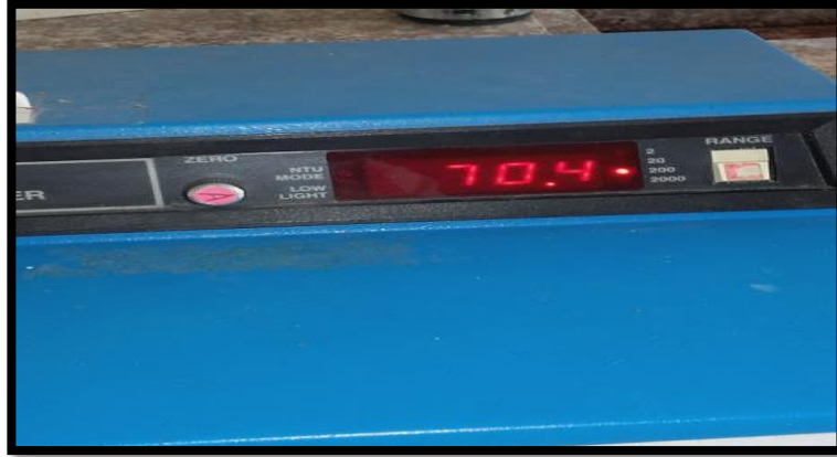
Fotografía 2.1 NTU final después del coagulante natural
