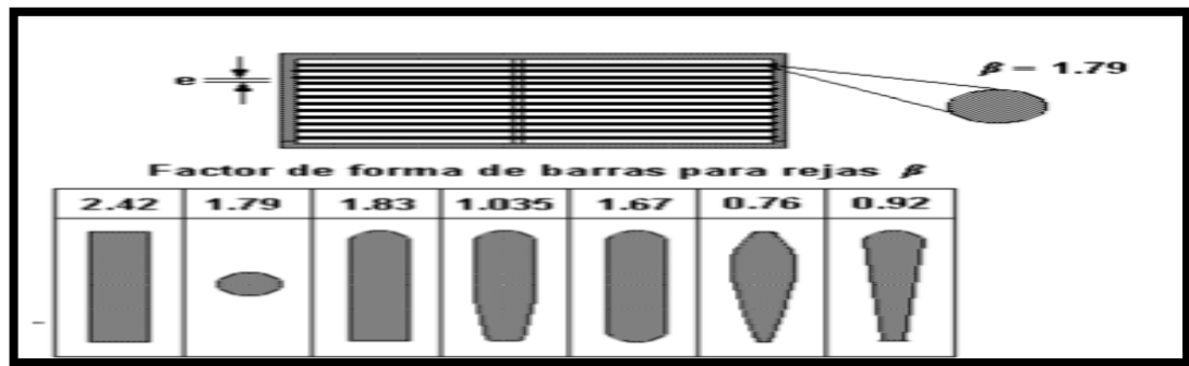
Figura 26.3 Factores de forma \beta para secciones usuales de barras de rejillas
