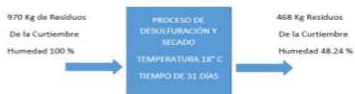
Gráfico 8-4: Proceso de desulfuración
