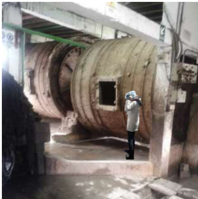
Figura 4-2 Bombo o 'fulón' para curtido de pieles
