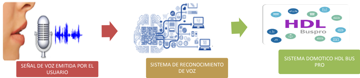
Figura 1. 1 Diagrama de bloques de un sistema domótico controlado por voz Realizado por: Chicaisa David. 2018
