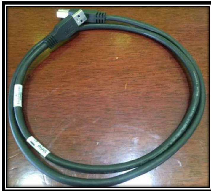
Figura 20-2: Cable de alimentación desde la pc a la tarjeta USRP
