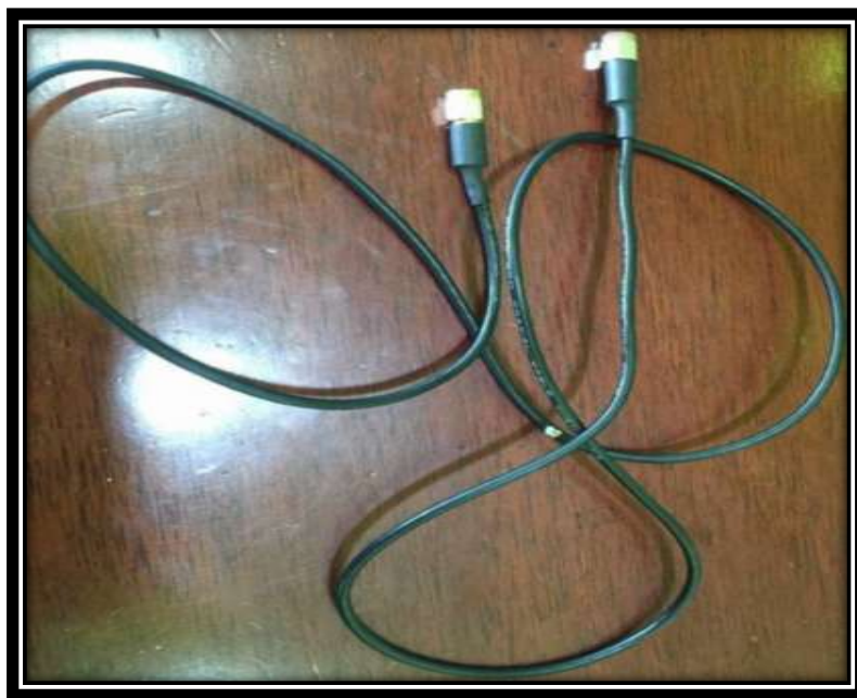
Figura 16-2: Cable SMA (RG 174) macho
