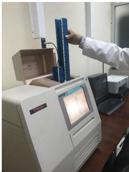
4. Automáticamente el equipo empieza a realizar el proceso de lectura de cada dosímetro, arrojando valores de dosis superficial y dosis profunda con su gráfica de energía y temperatura correspondiente.
