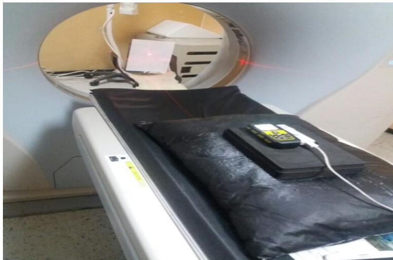
Fotografía 2-3: Movimiento de camilla, hasta alcanzar el punto de convergencia de los láseres.
