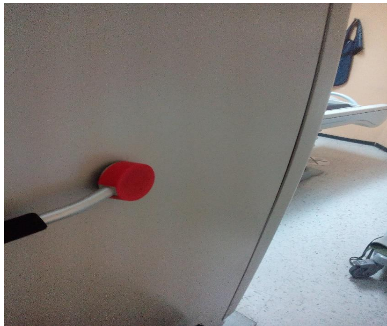
Fotografía5-3: Medición de radiación de fuga pared tomógrafo.
