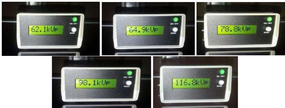
**Fotografía 10-3.** Medidas de kilovoltaje obtenidas por el detector.
