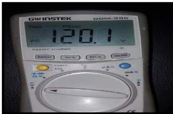
**Fotografía 18-3.** Tensión de 110 VCA medida con el multímetro en paralelo.
