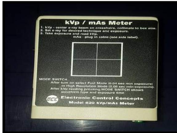
**Fotografía 9-3.** Detector de kilovoltaje, miliamperaje y carga ECC.
