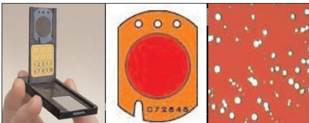
Figura 2-2: Detector de Radón de tipo LR-115 (En la parte central una lámina de LR-115)
