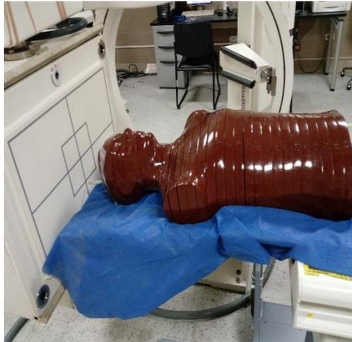
**Figura 19-4.** Posicionamiento del fantoma en la gammacámara.
