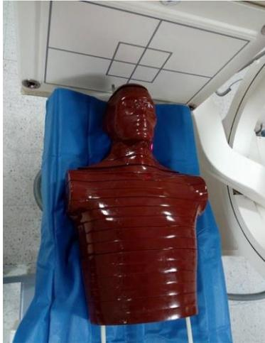
**Figura 7-4.** Posicionamiento del fantoma en la gammacámara.
