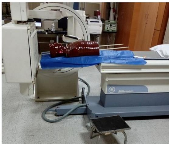
**Figura 3-4** Posicionamiento del fantoma en la Gammacámara.
