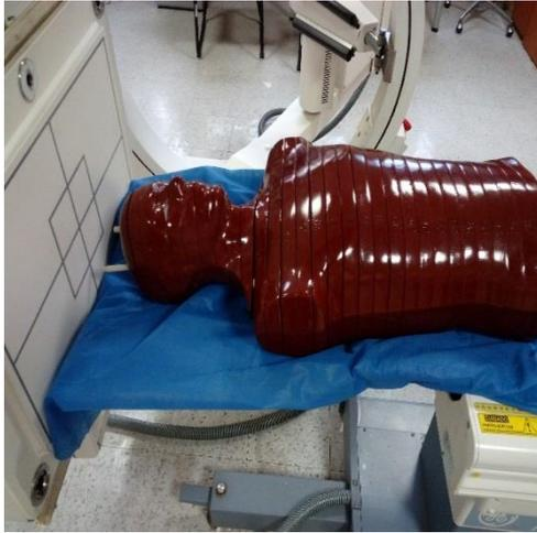
**Figura 15-4.** Posicionamiento del fantoma en la gammacámara.
