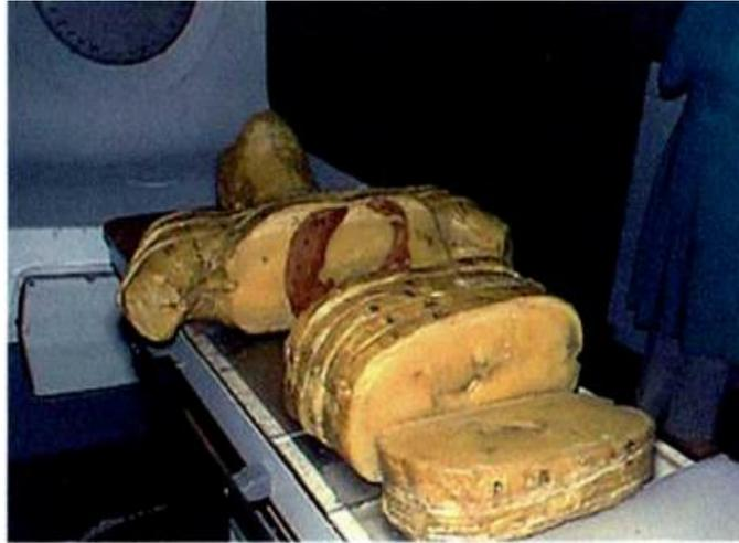
**Figura 4-2.** Vista interior de mediciones con cámaras de ionización y placas radiográficas, fantoma utilizado en la medición de campos supradiafragmáticos.
