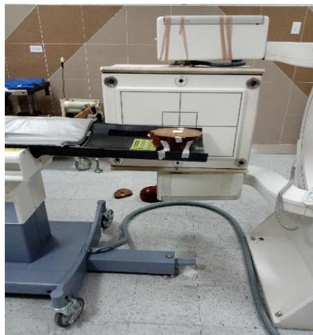
**Figura 26-4.** Posicionamiento lateral del fantoma antropomorfo en la gammacámara en diferentes puntos de las rodajas de cabeza y cuello.
