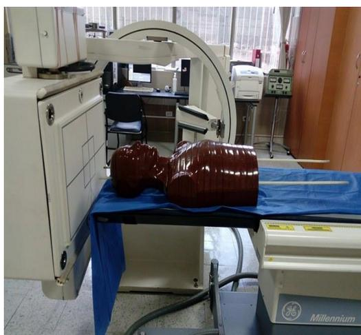
**Figura 11-4.** Posicionamiento del fantoma en la Gammacámara.
