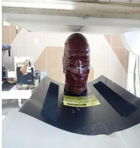
**Figura 25-4.** Posicionamiento anterior del fantoma antropomorfo en la gammacámara en diferentes puntos de las rodajas de cabeza y cuello.
