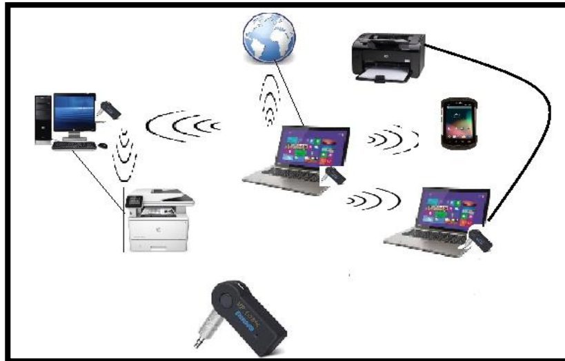
Figura 4-2: Topología del Bluetooth Elaborado por: (Saida Contreras, 2018)
