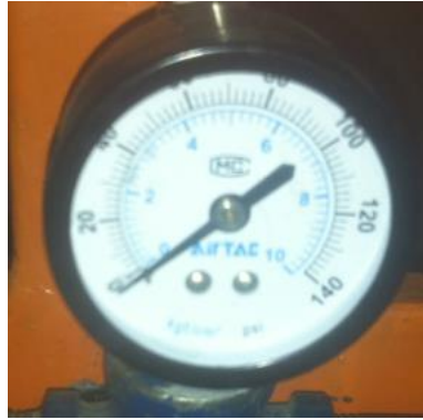
Figura 1-3. Manómetro instalado en el banco de pruebas de hidrociclón
