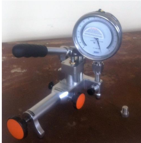
Figura 7-4. Montaje de los sensores de presión en la balanza
