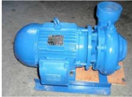
Figura 2-4. Conjunto de motobomba
