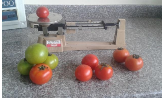
Figura 2-8. Ensayo de masa para cada tamaño de tomate Daniela
