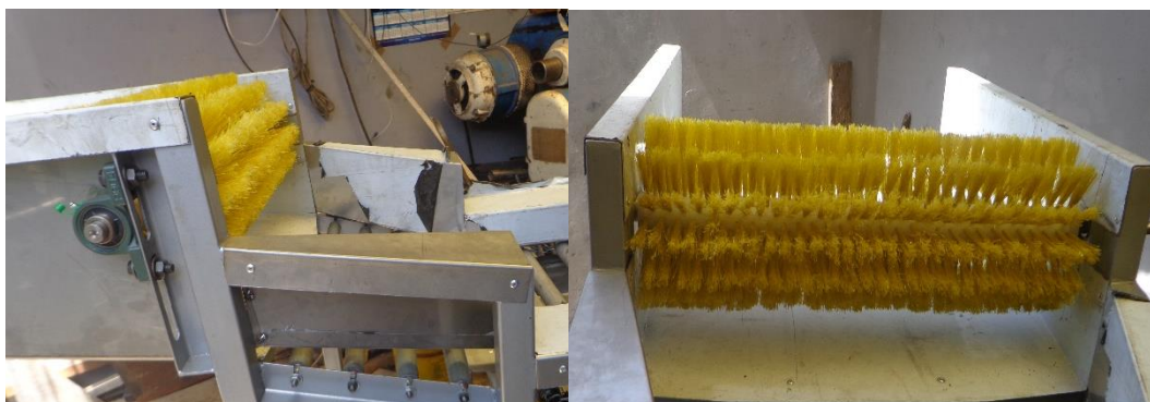
Figura 5-16. Montaje de las escobillas de limpieza
