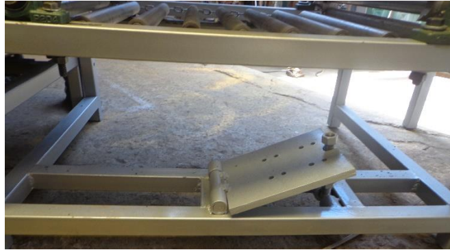
Figura 5-5. Perforaciones placa base del motor
