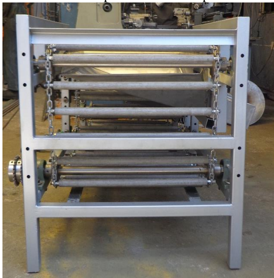
Figura 5-4. Perforaciones para unir las dos partes de la estructura
