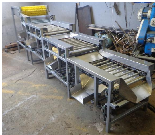
Figura 5-18. Máquina clasificadora de tomate riñón- variedad Daniela
