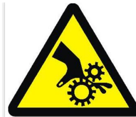
Figura 6-3. Riesgo de atrapamiento
