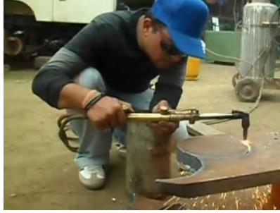
Figura 5-9. Esquema de corte por suelda oxiacetilénica
