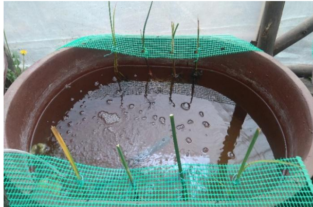
Fotografía 2-5: Biofiltro conformado por agua de la Laguna de Colta, Totora y Oxigenación Realizado por: Diana Quintana, 2017.
