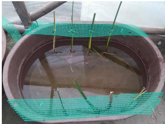
Fotografía 2-4: Biofiltro conformado por agua de la Laguna de Colta y Totora Realizado por: Diana Quintana, 2017.
