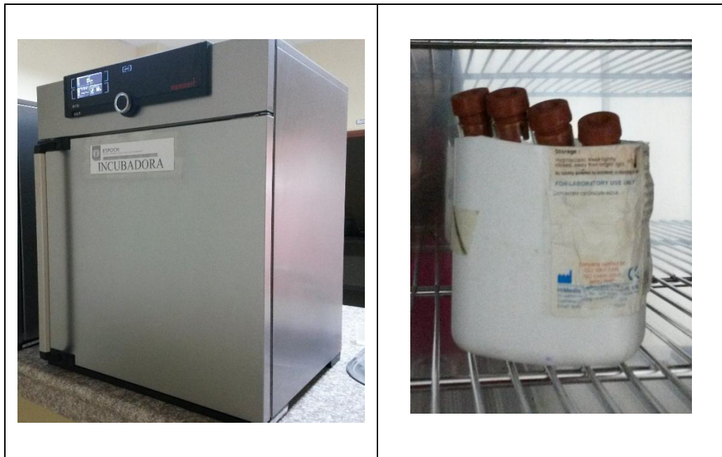
Fotografía 12-2: Aplicación de la prueba de hidrólisis de gelatina a 23°C a) Incubadora a 23°C y b) Tubos de ensayo a prueba a 23°C
