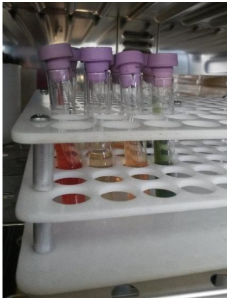
Fotografía 4C: Pruebas bioquímicas en la estufa a 30 °C
