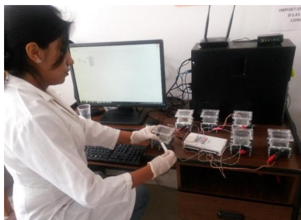
Fotografía 3D: Inyección de sustrato (nitratos) durante el monitoreo
