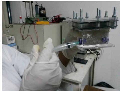
Fotografía 19-2: Inyección de los 5 mL de glucosa
