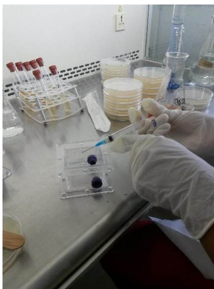
Fotografía 16-2: CCMs armadas y desinfectadas
