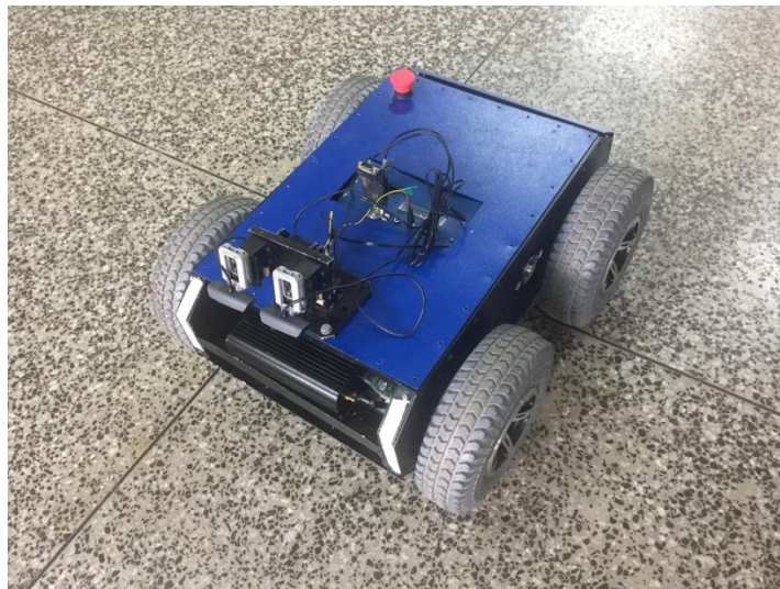
Figura 4-3: Robot móvil tipo unicycle Fuente: ASQUI PAGUAY, Leonardo Manuel, 2017.
