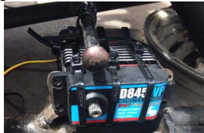
Figura 7-4. Instalación del servomotor
