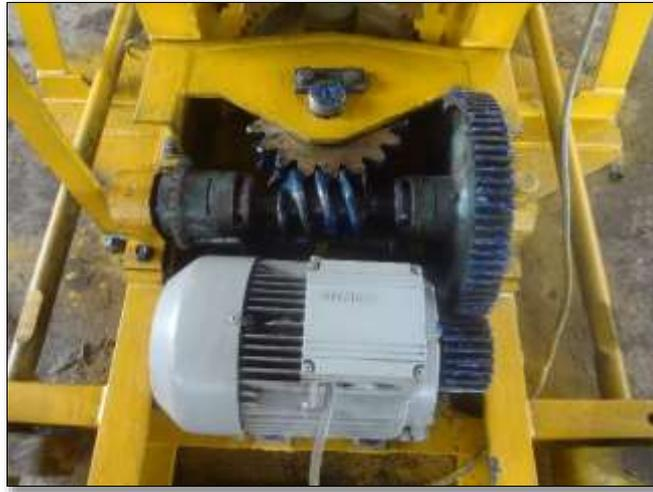
**Figura 13-5:** Montaje del universo de engranajes
