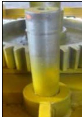
**Figura 26-2:** Eje de soporte del engranaje helicoidal combinado con engranaje recto
