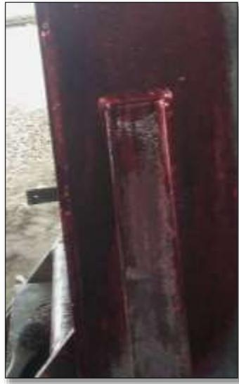
**Figura 39-3:** Penetrante en superficie
