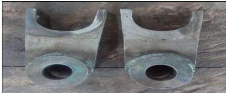
**Figura 28-2:** Conexiones del eje de soporte y eje del tornillo sin fin
