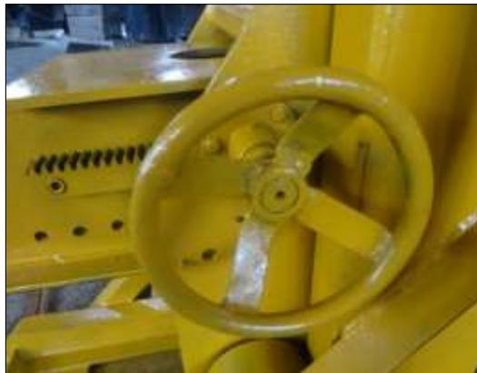
**Figura 18-2:** Desplazamiento manual del brazo
