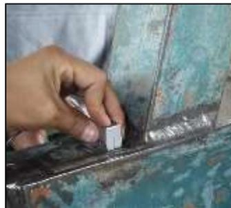
**Figura 45-3:** Transductor en la suelda
