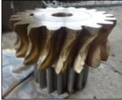
**Figura 25-2:** Engranaje helicoidal combinado con engranaje recto
