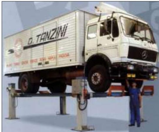
**Figura 4-2:** Elevador de 4 columnas electromecánico
