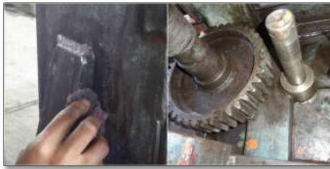
**Figura 9-5:** Limpieza de la estructura del elevador electromecánico
