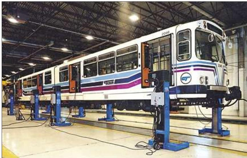
**Figura 1-2:** Elevador electromecánico de columnas móviles
