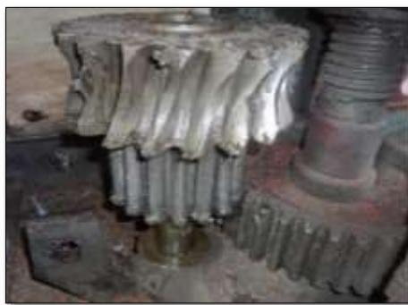
**Figura 5-5:** Desmontaje del engranaje helicoidal combinado con el engranaje recto.
