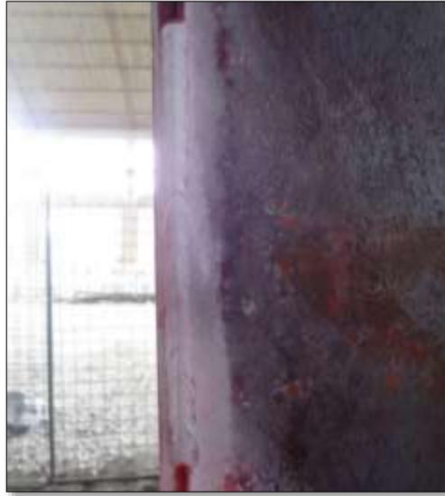
**Figura 41-3:** Aplicación del revelador
