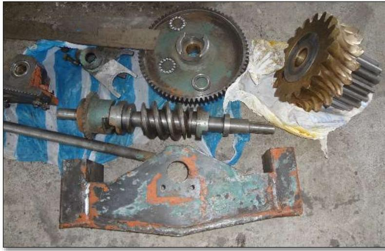
**Figura 6-5:** Partes del universo de engranajes
