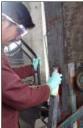
**Figura 38-3:** Aplicación de penetrante
