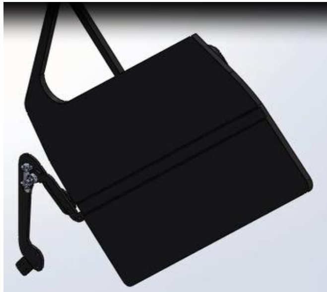
Figura 3-12. Ensamblaje de la bisagra y puerta vertical Fuente: Autores
