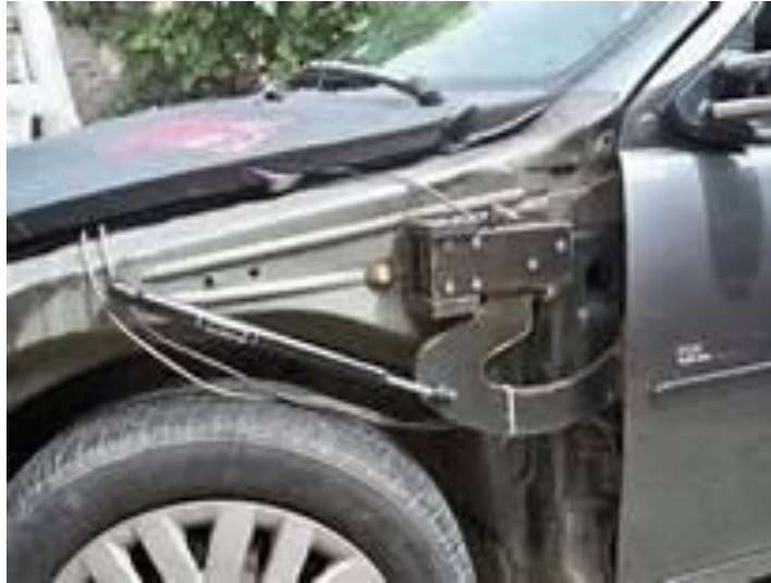
Figura 2- 9: Montaje de una bisagra tipo tijera Fuente: Todoautos.com.pe
