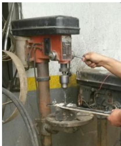
Figura 3-33. Agujeros para la regulación del amortiguador.
