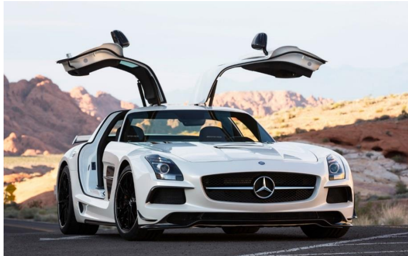
Figura 2- 4: Puertas ala de gaviota Fuente: Deftracing
