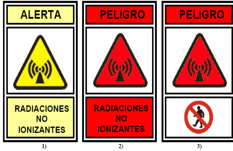
Figura 8-1: Señalización visual de las diferentes zonas de exposición a RNI Fuente: http://www.paritarios.cl/especial_letreros_tarjetas_seguridad.htm
