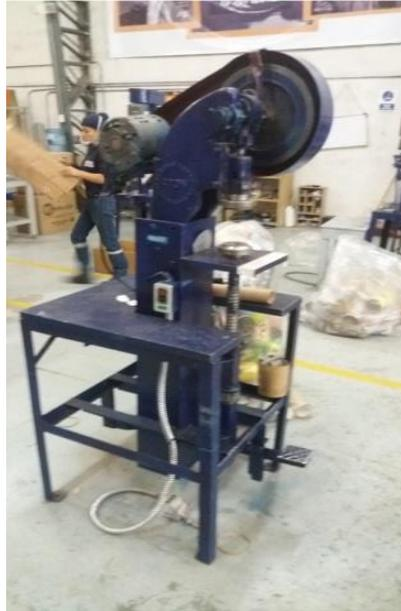
**Figura 14-3:** Troqueladora para el prensado
