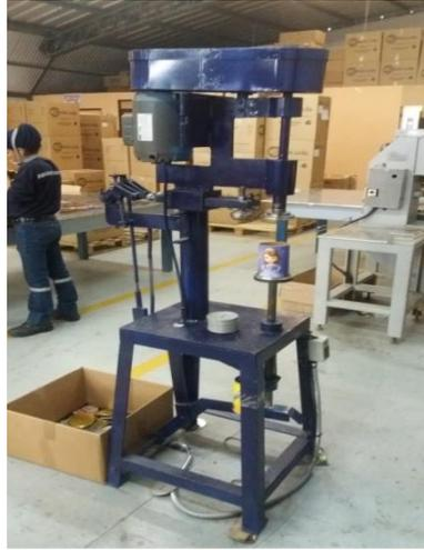
**Figura 15-3:** Troqueladora proceso de sellado
