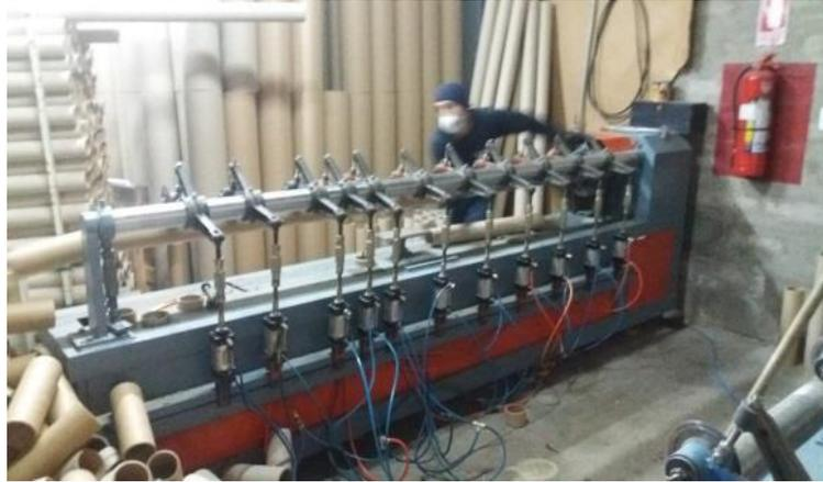
**Figura 7- 3:** Refiladora proceso de corte del tubo
