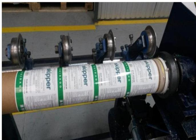
**Figura 13-3:** Refiladora procesos de corte
