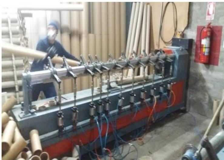
**Figura 6-3:** Refiladora proceso de colocación del tubo
