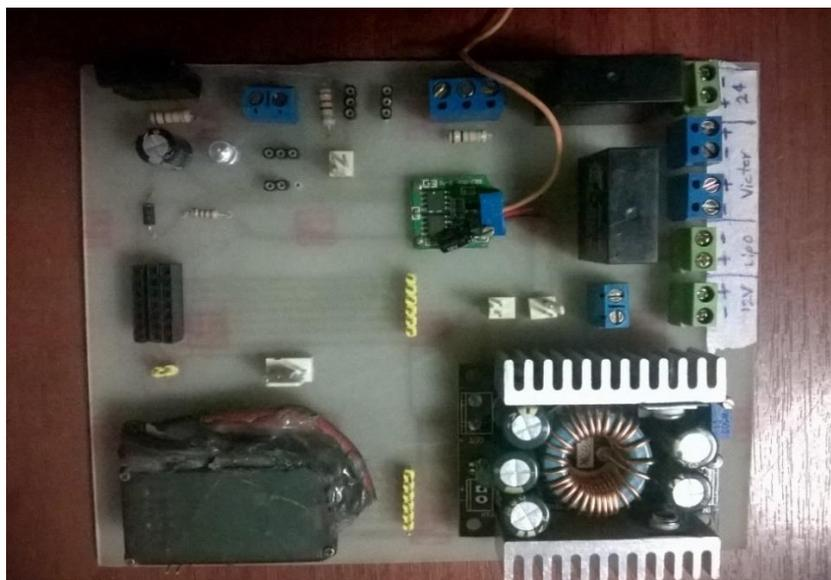
Figura 19-3. Placa PCB del sistema de control y monitoreo del robot.
