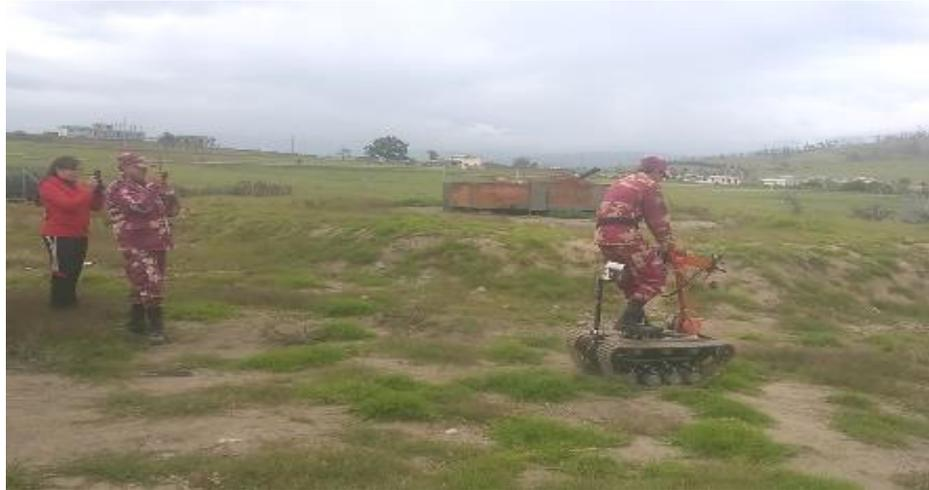
Figura 6-4. Prueba de peso adicional sobre el robot con un bombero de 60 Kg.
