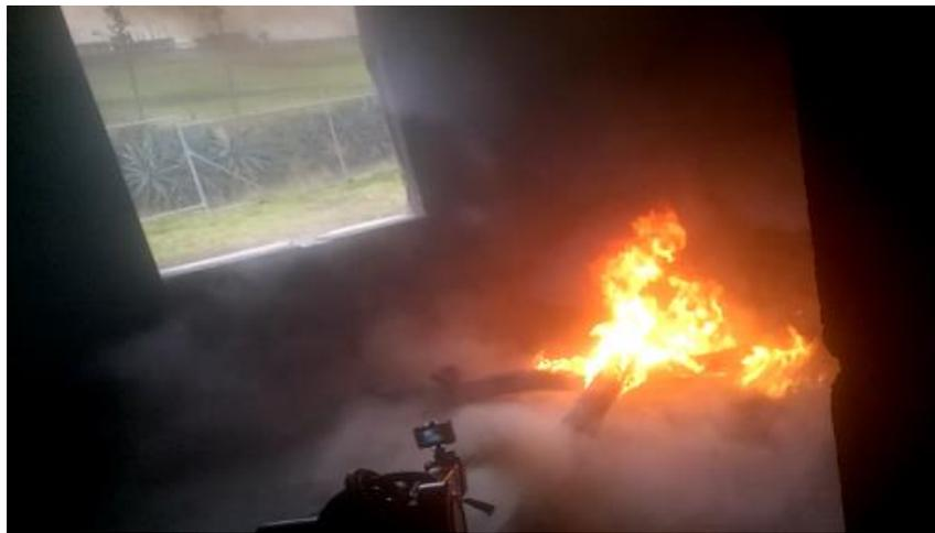
Figura 8-4. Prueba de mitigación de incendio de baja escala en la casa de humos.
