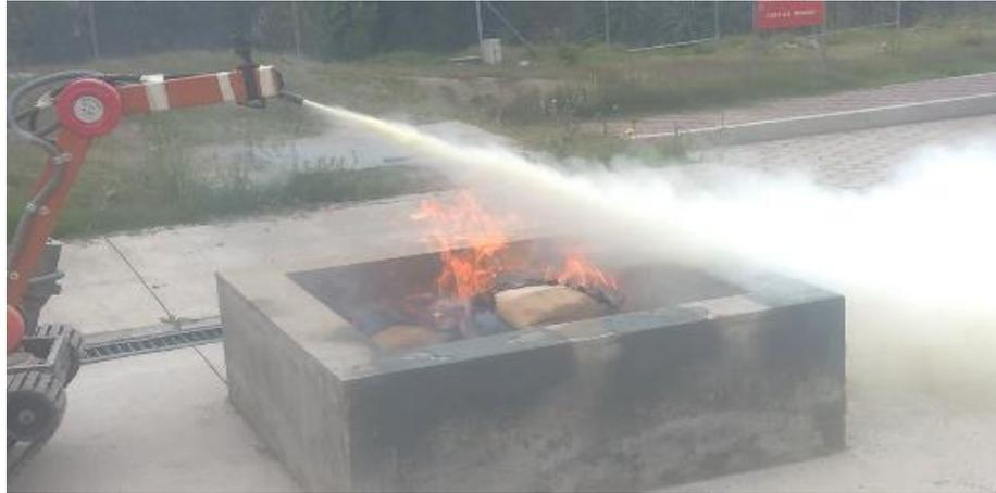
Figura 7-4. Prueba de mitigación de incendio de baja escala en paila de fuego.
