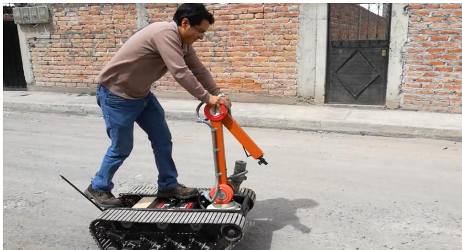
Figura 5-4. Prueba de peso adicional sobre el robot con una persona de 65 Kg.
