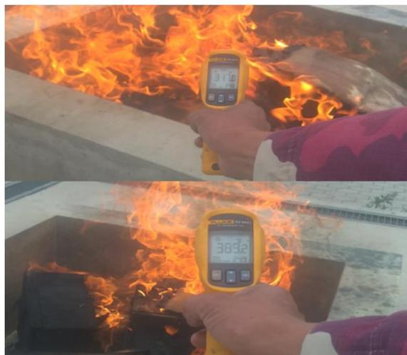
Figura 11-4. Muestras de temperatura del incendio y soportadas por el robot.
