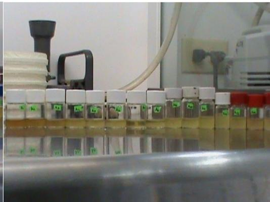
**FOTOGRAFIA 23. Juego de Frascos de Arrayan para prueba de Macrodilución en caldo para CIM después de 24 horas.**
