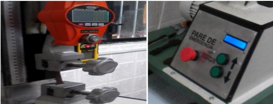
Fotografía 1. Equipo para la medición de la resistencia a la tensión.
