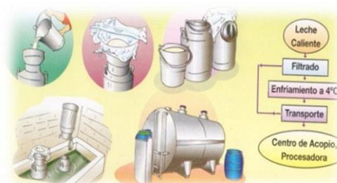
Grafico14.Procedimiento del enfriamiento de la leche.
