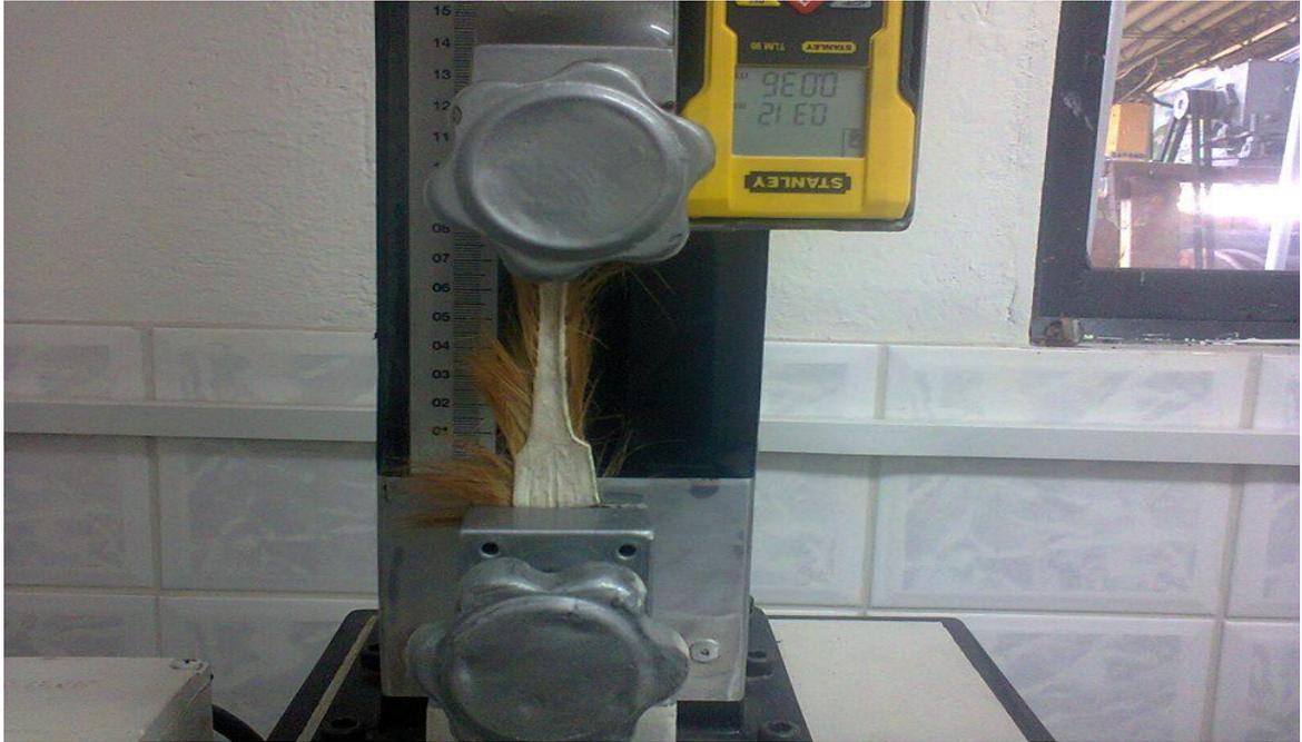
Gráfico 6. Partes de un equipo para realizar la medición de la resistencia al frote en seco.
