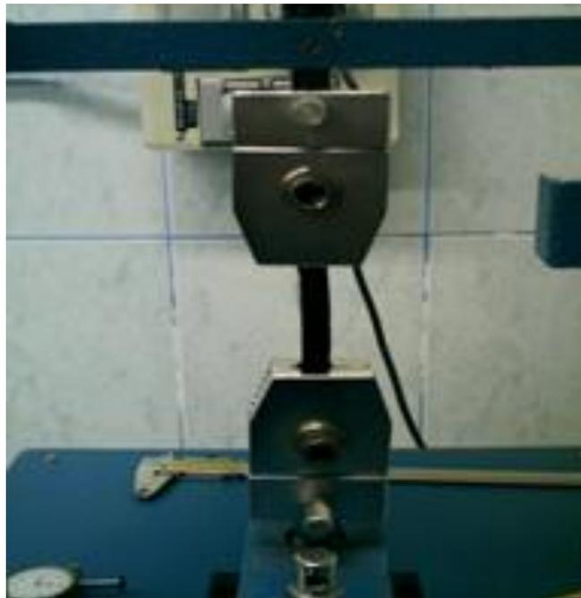
Gráfico 9. Colocación de la probeta de cuero entre las mordazas tensoras.
