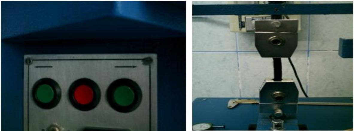
Gráfico 11. Puesta en marcha del prototipo mecánico para medir la resistencia a la tensión del cuero.
