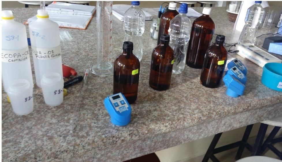
**Figura 7-3:** Preparación de muestras para el análisis DBO de acuerdo al método HACH 8043.
