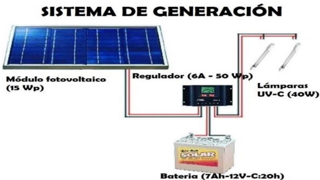
Figura 13-2: Diagrama del sistema de generación eléctrica fotovoltaica
