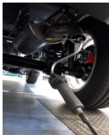
Figura 31. Sonda de diagnóstico insertada
