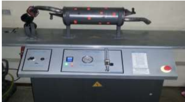
Figura 35. Banco de pruebas, ensayo de estanqueidad
