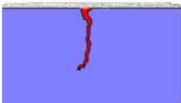
Figura 15. Aplicación del Revelador
