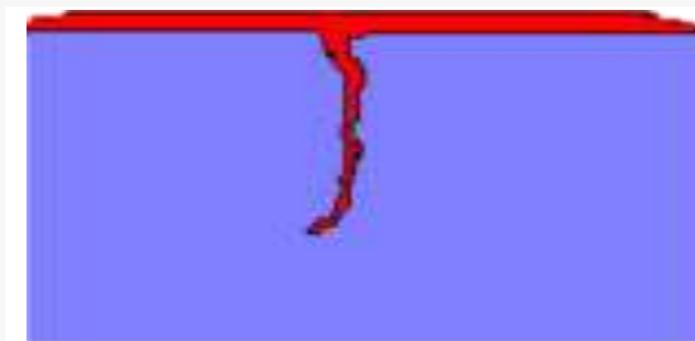
Figura 13. Aplicación del penetrante
