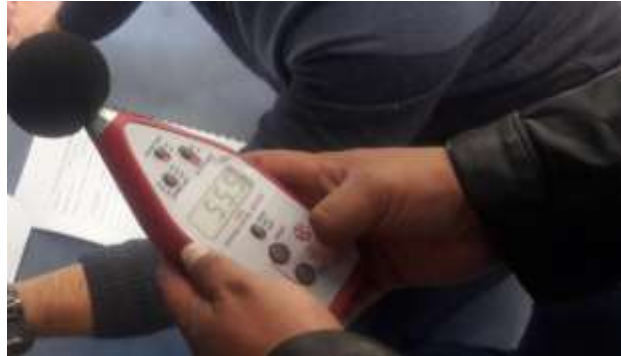
Figura 34. Sonómetro con uno de los valores obtenidos
