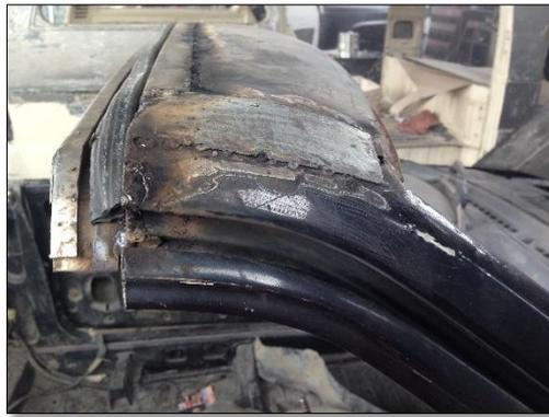
**Figura 70-4:** Refuerzo en los pilares del parabrisas delantero.
