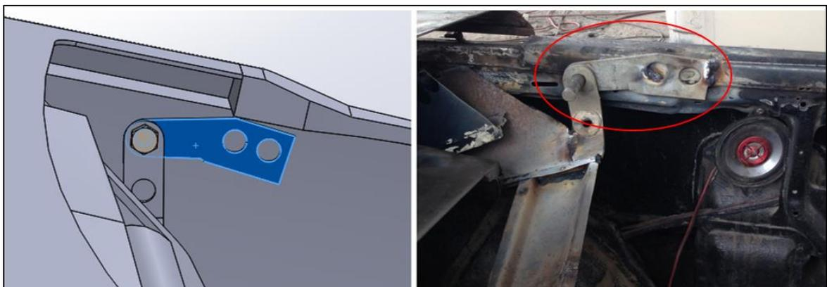
**Figura 46-3:** Carrocería con refuerzos laterales y bisagras posteriores
