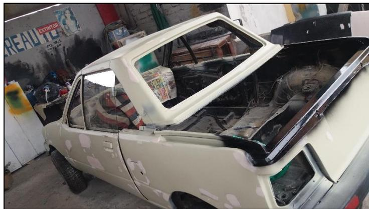
**Figura 75-4:** Preparación del auto para pintura
