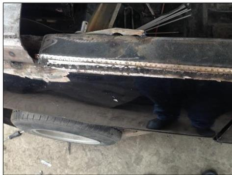
**Figura 71-4:** Refuerzos Laterales en la carrocería
