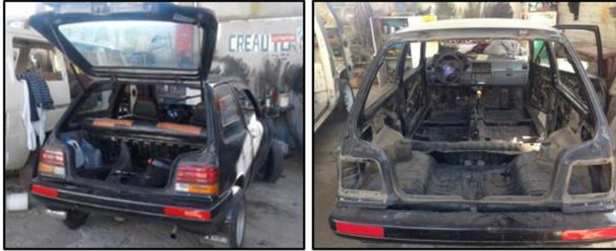
**Figura 64-4:** Desmonte de accesorios y componentes del habitáculo
