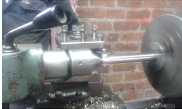
**Figura 85.** Roscado de la punta de eje guía.
