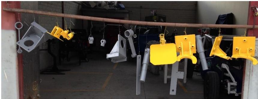
**Figura 99.** Elementos pintados en proceso de secado
