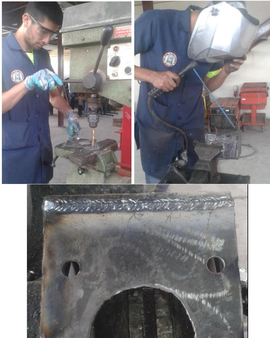
**Figura 88.** Perforación y soldadura de las bases del cilindro neumático
