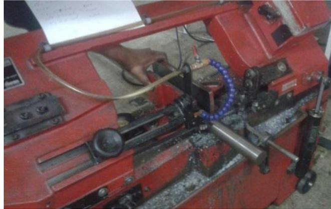
**Figura 86.** Corte del eje de acero de transmisión
