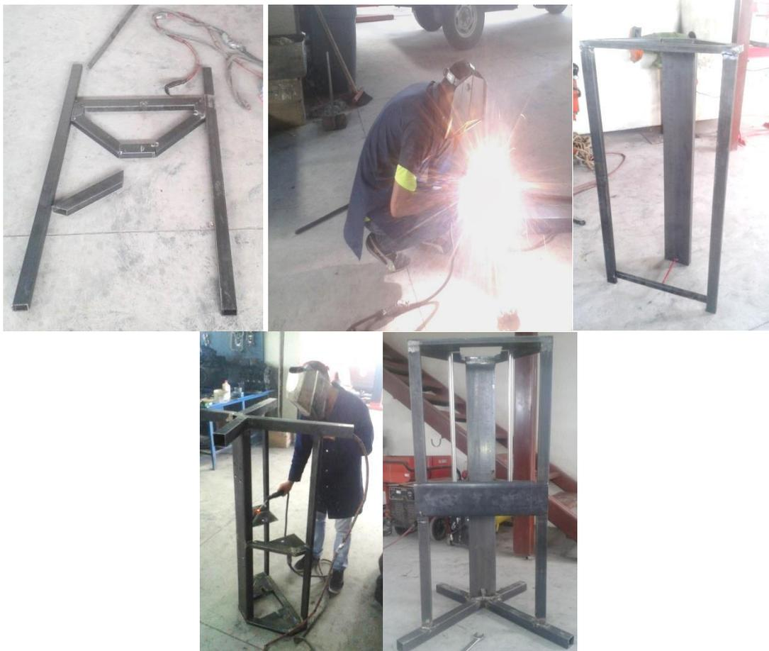
**Figura 84.** Corte y montaje de los perfiles estructurales
