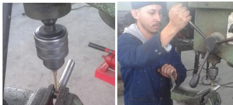
**Figura 92.** Perforación del eje roscado
