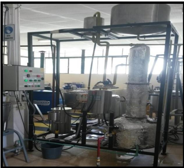
**Figura 8-3: Torre de destilación en el laboratorio de Procesos Industriales**
