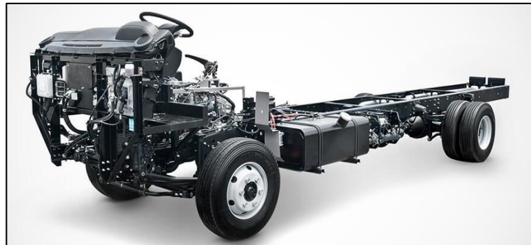
Figura 4-3: Chasis para bus interprovincial Fuente: Corporación Megabuss.
