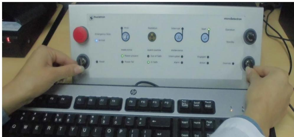
**Figura 21-3.** Llaves colocadas en el panel de control de tratamiento.
