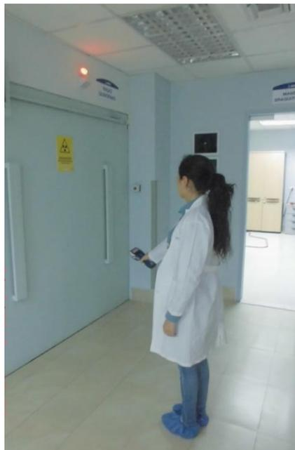
**Figura 72-3.**Medición de la salida de radiación de la sala de tratamiento a 1m.
