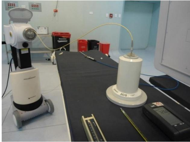
**Figura 31-3.** Posicionamiento de la cámara de pozo
