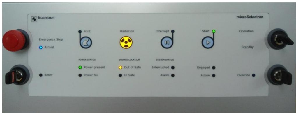
**Figura 53-3.**Indicador de la salida de la fuente, presencia de radiación.
