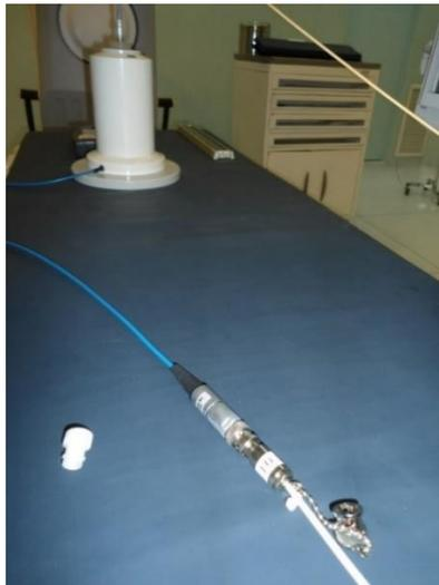
**Figura 32-3.** Cámara de pozo conectada hacia el electrómetro.
