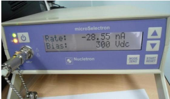
**Figura 33-3.**Electrómetro +300V
