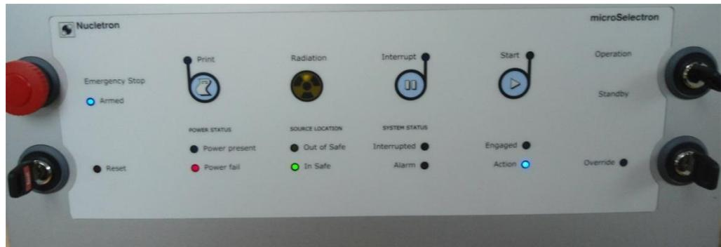
**Figura 60-3.**Indicador del uso de las Baterías de respaldo en el Panel de control de tratamiento.
