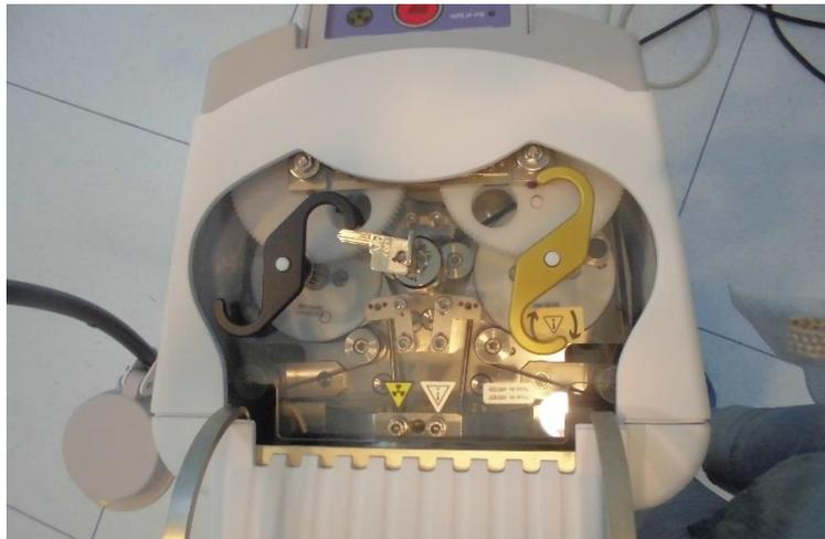
**Figura 9-3.**Manivela dorada para el retorno manual de la fuente.
