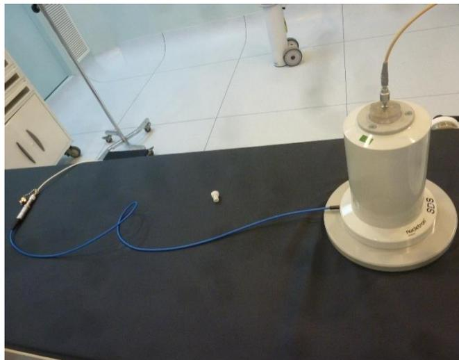
**Figura 1-3.** Cámaras de ionización de tipo pozo
