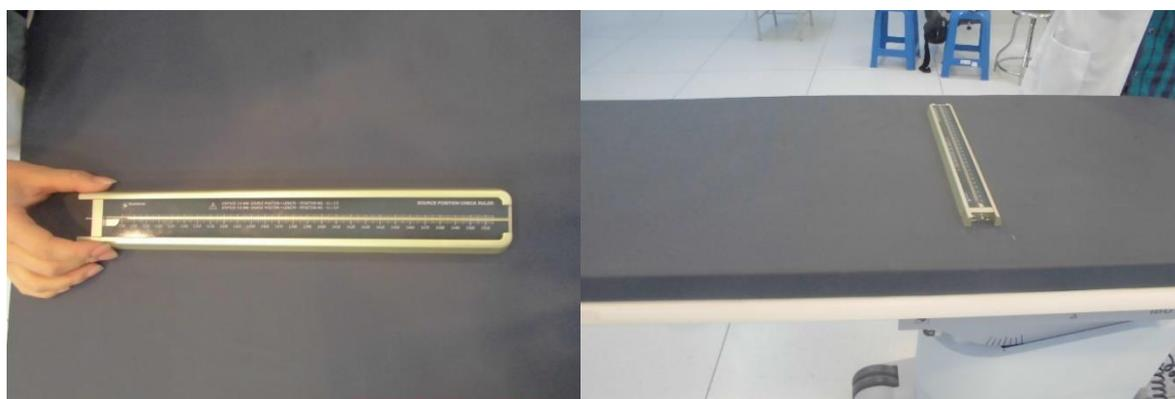
**Figura 14.**Regleta de chequeo de posición de la fuente para control de calidad.
