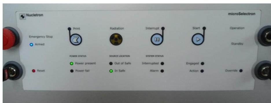
**Figura 57-3.** Ejecución del botón de parada de emergencia en TCS.
