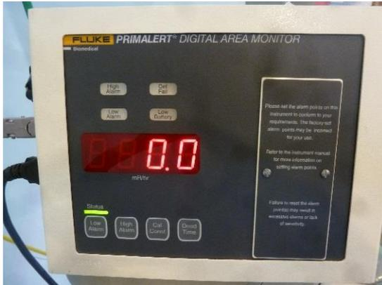
**Figura 5-3.** Monitor estacionario de radiación primalert.
