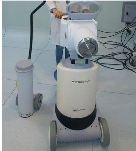
**Figura 37-3.**Equipo de carga diferida a control remoto (microSelectron-HDR).
