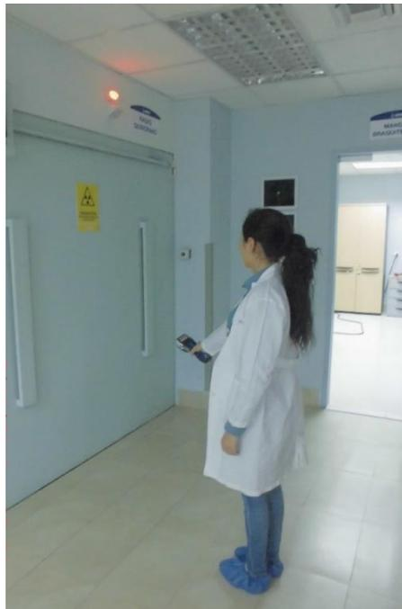
**Figura 22-3.**Medición de la contaminación ambiental de la sala de tratamiento a 1m de la puerta.
