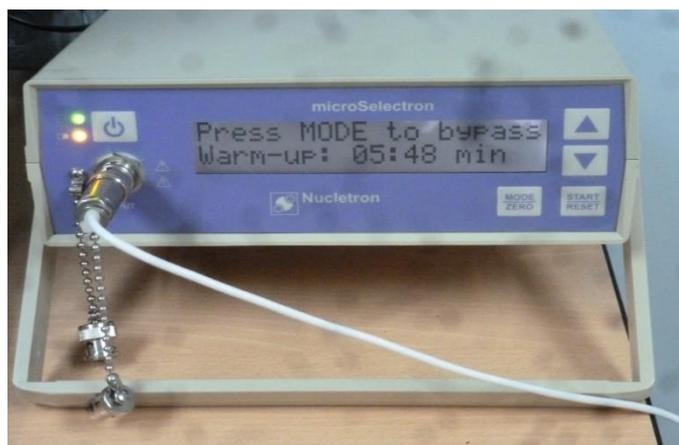
**Figura 2-3.**Electrómetro microSelectron de la marca Nucletron
