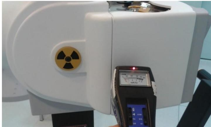
**Figura 73-3.**Medición de la fuga de radiación del equipo en contacto con el detector.
