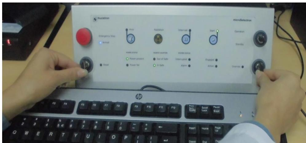
**Figura 71-3.** Colocación de las llaves en el panel de control de tratamiento.
