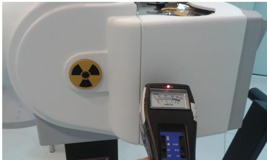
**Figura 23-3.**Medición de fuga de radiación del equipo.
