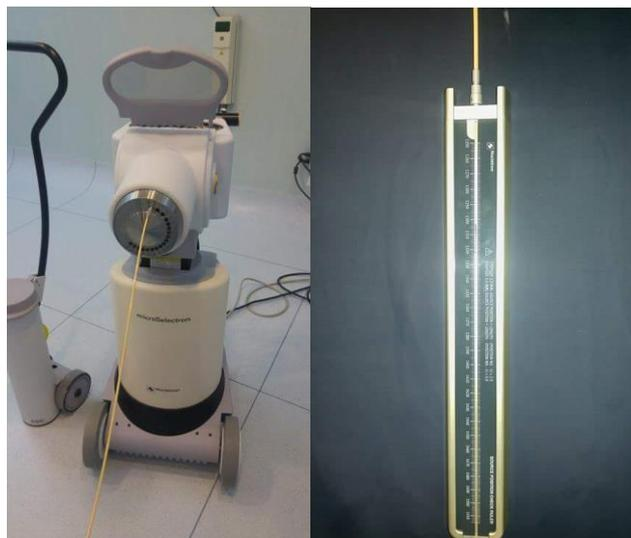
**Figura 38-3.**Posicion del aplicador desde el equipo de alta tasa de dosis hacia la regleta.
