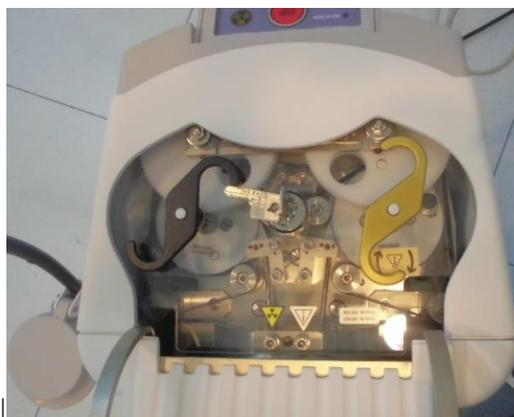
**Figura 4-3.**Cabezal de la Unidad de tratamiento
