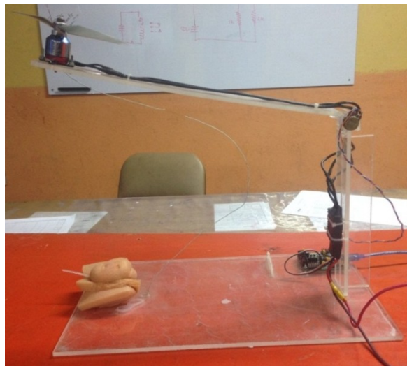
Figura 2-2: Protecciones para vuelo y aterrizaje del Brazo Robótico Realizado por: Verónica Altamirano
