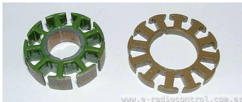
Figura 19-1 Estatores de CD-ROM y disco duro respectivamente Fuente: E-radiocontrol.com.ar. Motores_Brushless:Estatores_y_esquemas_de_bobinados
