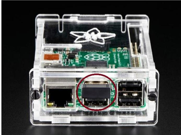
**Figura 2-2 Adaptador wifi USB conectado**
