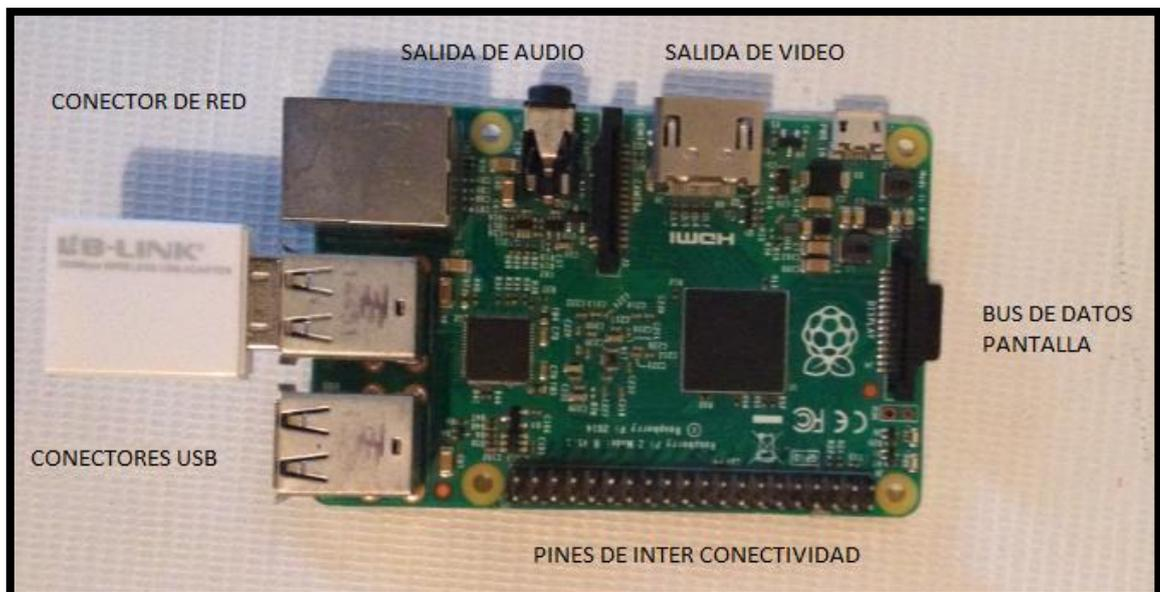
**Figura 4-2: Placa Raspberry 3 y sus partes**
