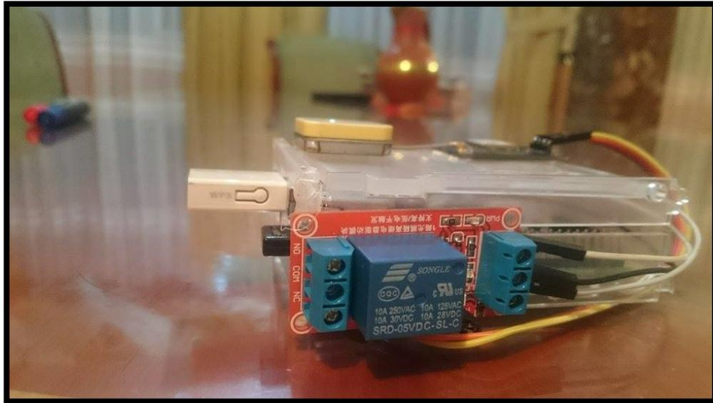
**Figura 7-3: Módulo de activación y desactivación del fluido eléctrico**
