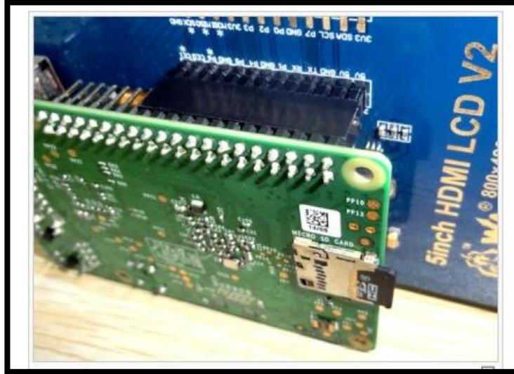
**Figura 17-1: Vista posterior de la conexión de los pines de la pantalla táctil y el Raspberry pi**
