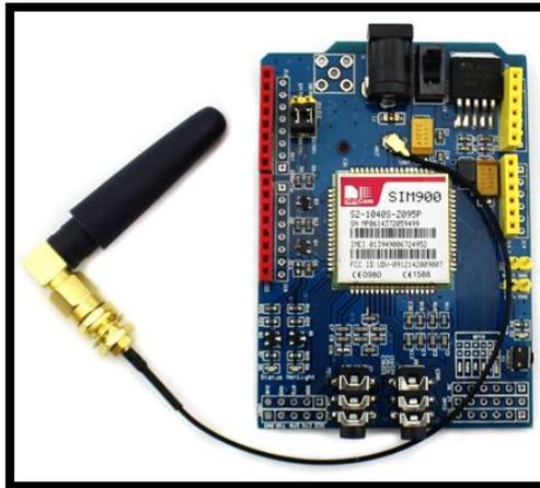
**Figura 13-1: Placa del GPRS**
