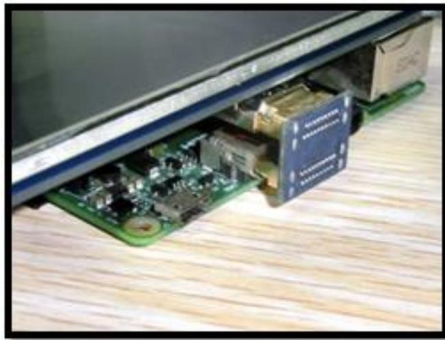
**Figura 14-2: Vista de la conexión del adaptador de la placa Raspberry y de la pantalla táctil**
