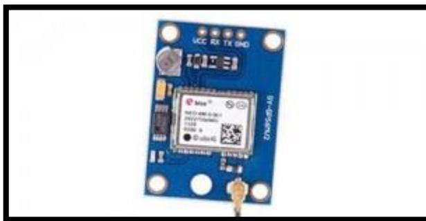
**Figura 10-1: Placa del Módulo Gps en la que se procesa la información**
