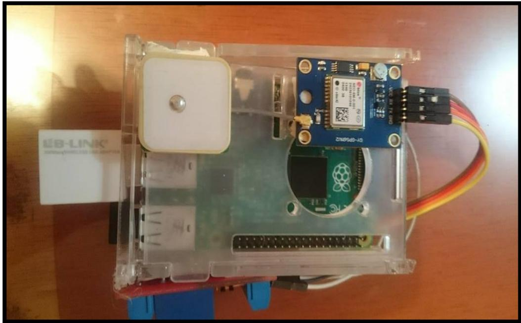
**Figura 5-3: Vista superior del Dispositivo**
