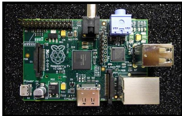
**Figura 1-1: Vista de una placa de Raspberry pi**
