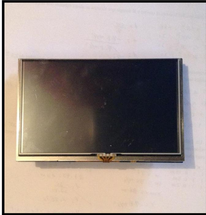
**Figura 13-2: Pantalla táctil utilizada con el Raspberry pi**
