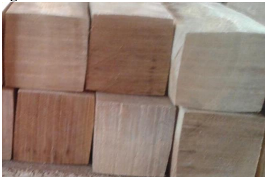
Figura. 15. Presencia de oxidación en MC3.
