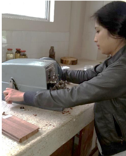
Figura. 60. Corte de las muestras con el micrótopo.
