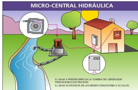
Figura 7. Lugar de instalación de la turbina Turgo
