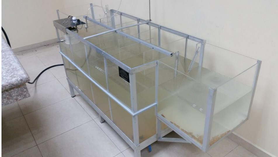
Fotografía 15. Floculador horizontal con agua tratada
