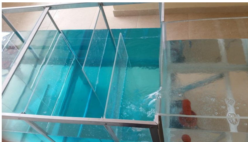
Fotografía 10. Transporte de azul de metileno a través de las pantallas del floculador horizontal
