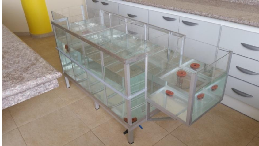
Fotografía 8. Floculador lleno de agua
