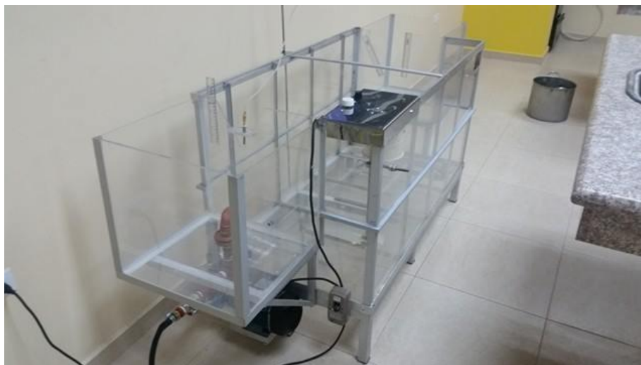
Fotografía 11. Implementación del sistema de agitación y dosificación.
