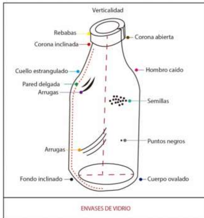
Figura 7-1: Partes de un envase de vidrio.
