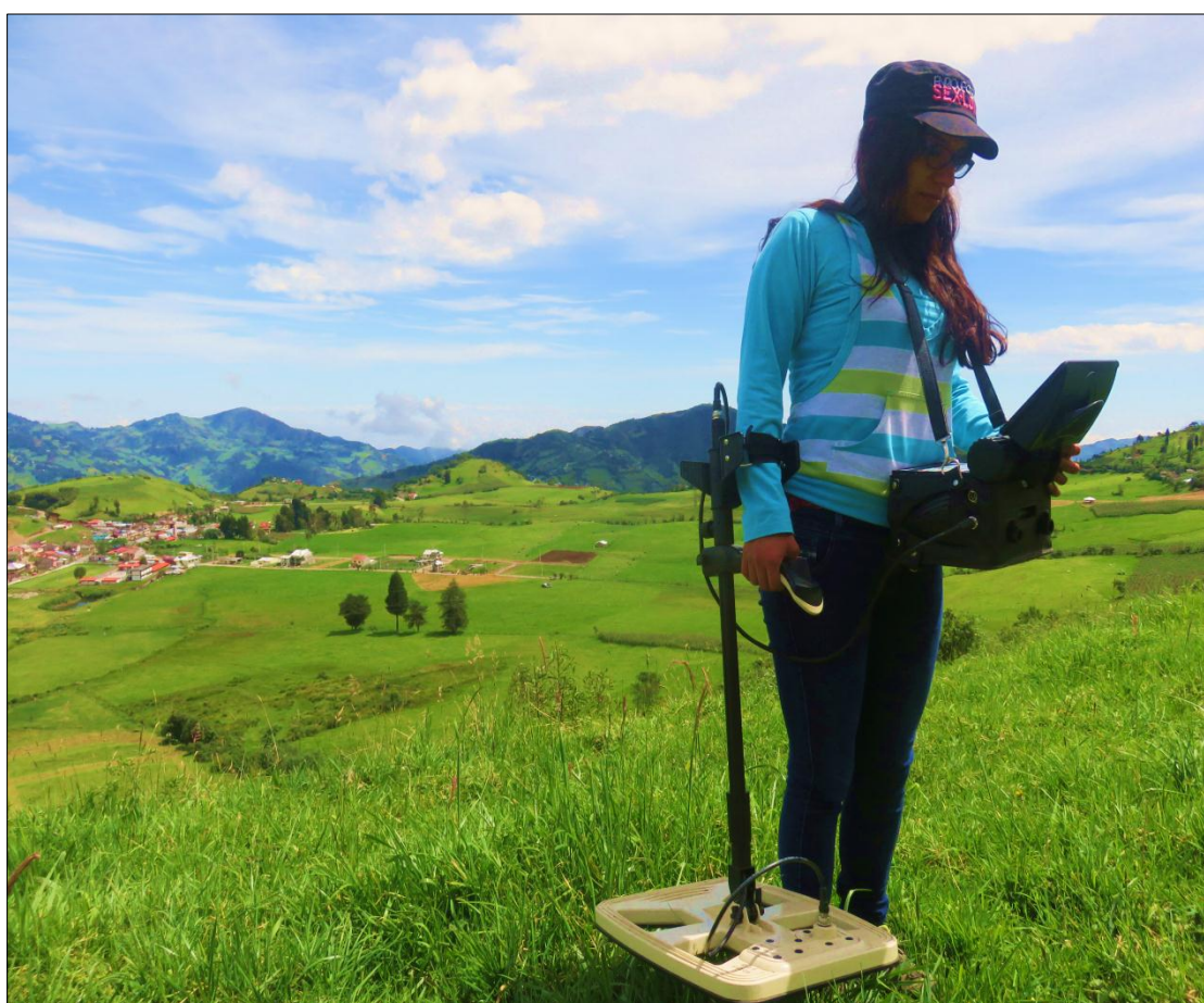
Figura 17-7: Prospección superficial realizada con el magnetómetro Nota: Prospección de campo, 2016
